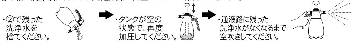
※特に、水和剤を使用した場合は、薬液が完全になくなるまで真水(水道水)を噴霧して本器内を洗浄してください。薬液がバルブ本体、ノズル内部に残ると固化して故障の原因になります。
