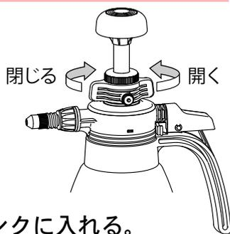
**!** 使用中、タンク内に圧力が残っているときにポンプを取り外すとタンク注入口から、中の薬液が勢い良く飛び出し危険ですので、ポンプ上部からウエスなどをかぶせてポンプを取り外すようにしてください。
