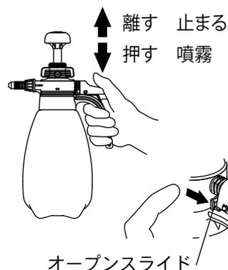
**⚠ 注意** 霧の調整は必ずノズルだけ回してください。内部にバルブ弁があるノズルアダプターを緩めると液漏れします。
