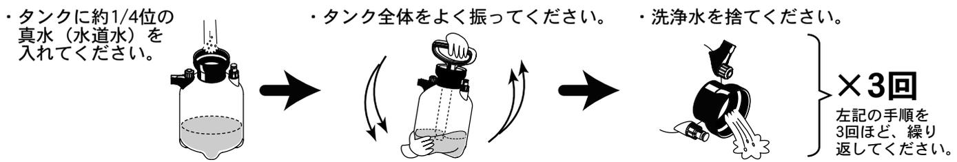
②本器の通液路を洗浄するために再度タンクに真水（水道水）を入れて加圧し、約1分間噴霧してください。
