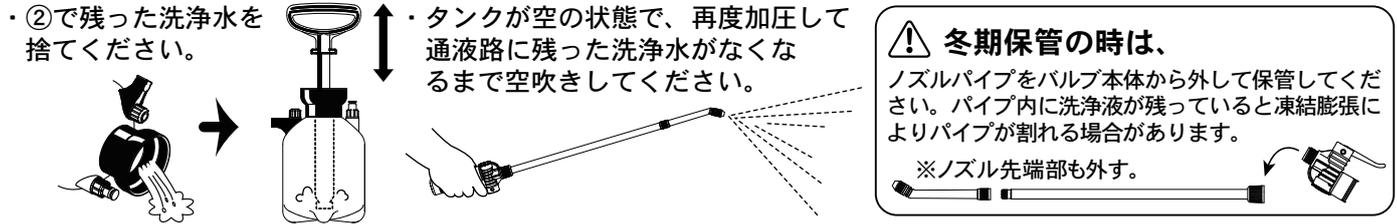
※特に、水和剤・石灰硫黄合剤・マシン油剤を使用した場合は、薬液が完全になくなるまで真水（水道水）を噴霧して本器内を洗浄してください。薬液がバルブ本体、ノズル内部に残ると固化して故障の原因になります。
