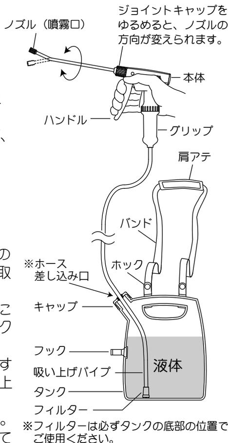
**⚠ 注意** タンクを逆さにするとキャップのホース差し込み口から液漏れします。
