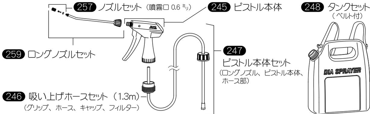
**注意** タンクを逆さにするとキャップのホース差し込み口から液漏れします。
